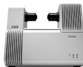
赤外/近赤外分光計 FT-IR/NIR 用途：測定対象の物質に赤外線を照射し、対象物の特性を知る装置
