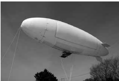
無線電力伝送装置を搭載した飛行船(高度30m)
