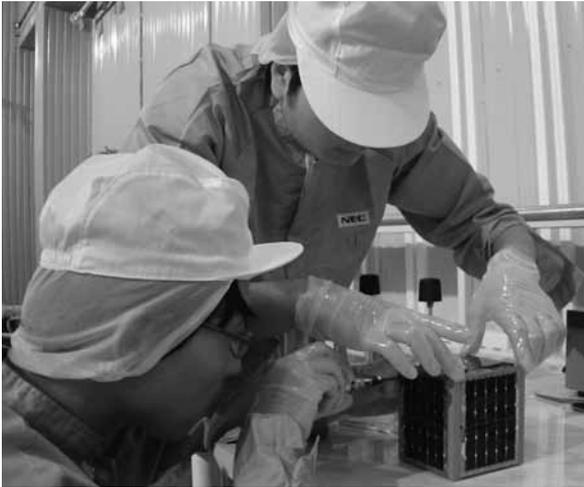
まさしく手作業によって組み立てられる超小型の人工衛星
