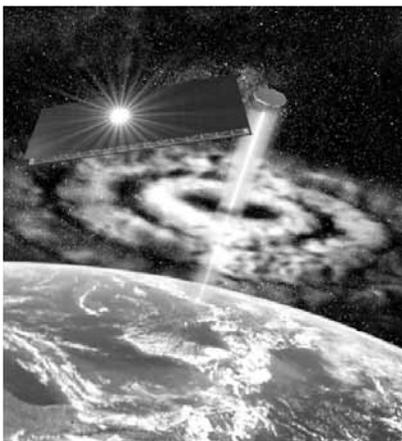
宇宙空間で太陽光発電を行い、その電気エネルギーを無線で地上に送る宇宙太陽発電所SPS構想
