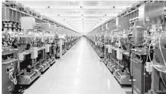
■真空封止アンジュレータによって、低い電子ビームエネルギーでもX線レーザーの発生が可能。
