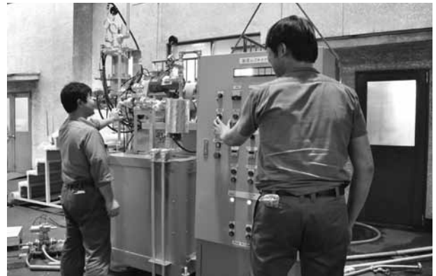
チップを短時間でスチーミングし、加圧下でレファニングする装置 「新型 KRK 加圧レファイナー」の試験テスト中
