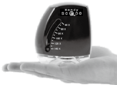
携帯デジタル色計測機能付き顕微鏡 HandyScope 高倍率・高画素で各種計測機能のコンパクトデジタル顕微鏡 光源はWhite LEDに加えUV及びIRのLEDを搭載 紫外線による蛍光画像や赤外線反射画像を取得 専用ソフトウェアで二値化処理や測長・面積計算及び物体色 L*a*b* 測定可能
