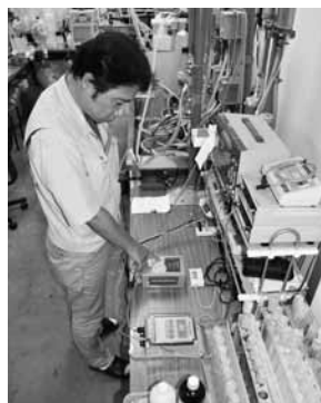
残留塩素計の適合性評価試験
