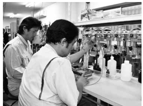
バラスト水処理装置用TRO(残留オキシダント)濃度計の 実液試験
