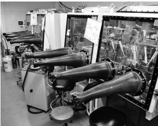
空気中で不安定な化合物を扱うためのグローブボックス
