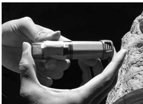
ICタグを現場記録の装置 (温湿度計)に付けた様子
