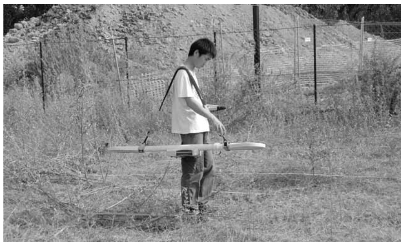
電磁誘導法による探査の様子
