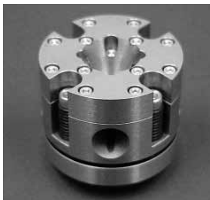
地球深部の環境を再現する際に不可欠な「アンビル」とよばれる装置のセル
