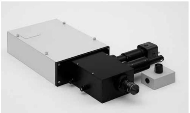
アイリックスで開発・製造している「顕微ラマン分光装置」（左）と「ラマンリモートプローブ」（右）
