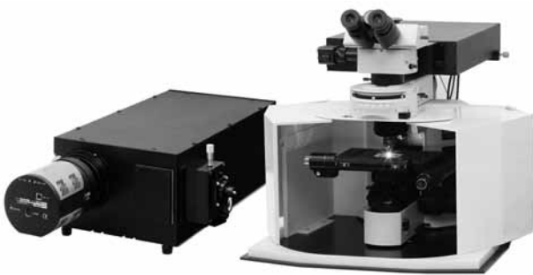
アイリックスで開発・製造している「顕微ラマン分光装置」（左）と「ラマンリモートプローブ」（右）
