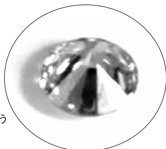
地球深部の環境を再現する際に不可欠な「アンビル」とよばれる装置のセル
