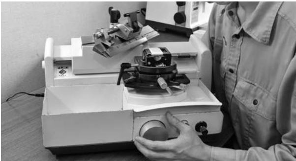
刃を前後に滑走させて試料を薄切にする滑走式マイクローム
