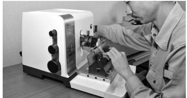
ハンドルを回して試料を上下させて試料を薄切にする回転式マイクローム
