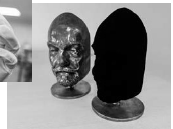
サリーナノシステムズ社 超低反射率ブラックコーティング Vantablack
