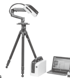
μ-X360s X線残留応力測定装置 X線の回折現象を利用して非接触、非破壊測定!誰でもどこでも簡単に操作することができます。金属の「割れ」「ひずみ」「反り」「曲がり」等の原因とされる残留応力、半価幅、残留オーステナイトを測定します。
