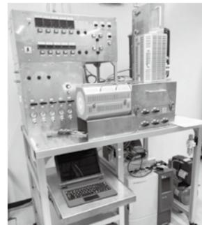
ガス透過膜試験装置
