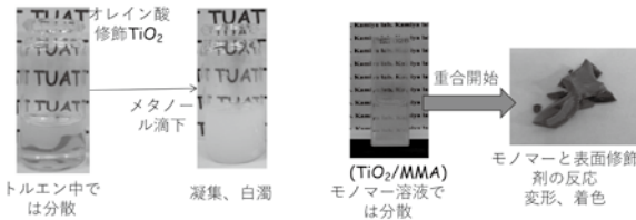
図2 溶媒物性の変化で凝集、重合時の反応で変形など課題の事例
