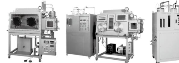
バジ式ガス循環精製装置付 卓上型真空引き式 ガス循環精製装置
