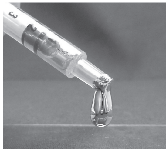
室温で液体状態を保つガリウム系合金であり、高い導電性と柔軟性を併せ持つ次世代材料である。
